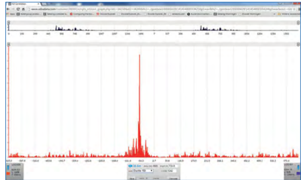
Corrélation en ligne des données acoustiques d'un réseau de logger de bruit Sebalog N-3
